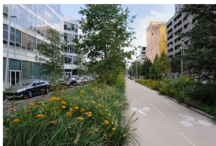
Piste cyclable bidirectionnelle séparée de la circulation par une bande plantée
